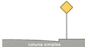
O afastamento lateral das placas, medido entre a borda lateral da mesma e da pista, deve ser, no mínimo, de 0,30 metros para trechos retos da via, e 0,40 metros nos trechos em curva.
