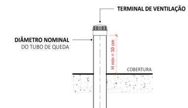
**03** DETALHE TERMINAL DE VENTILAÇÃO
