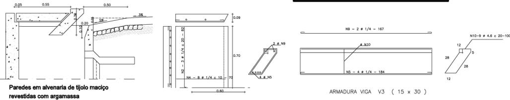
Paredes em alvenaria de tijolo maciço revestidas com argamassa
