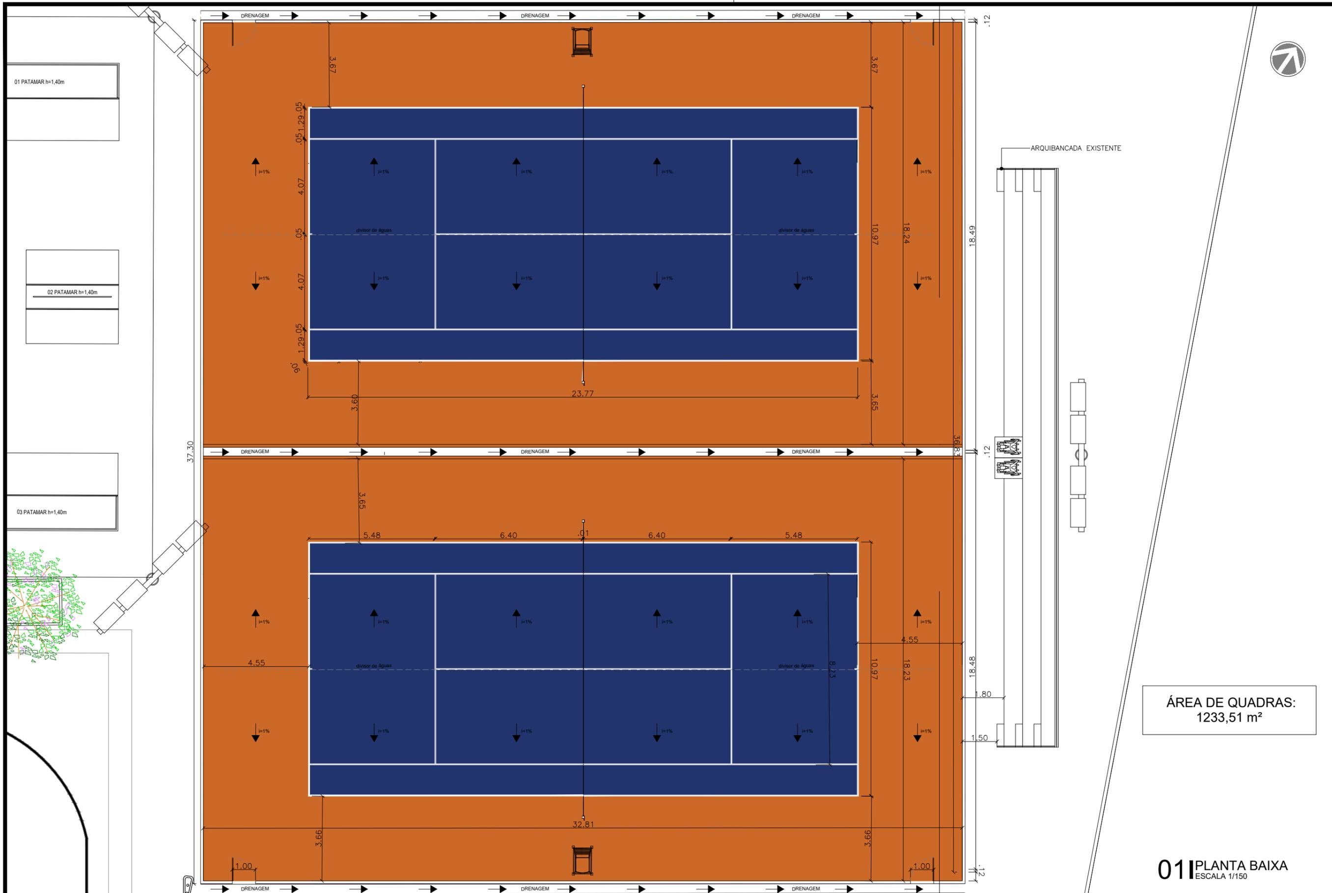
Obs.: Para cada quadra de tênis recomendado 4 postes de 9m de altura cada, equipados com 4 refletores LED de 300W, ou 3 refletores LED de 400W, ou então com 6 refletores LED de 200W.
