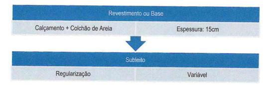
O calçamento será executado com Paralelepípedo proveniente de pedreiras da região. Todo o material indicado na pavimentação será adquirido e transportado comercialmente.
