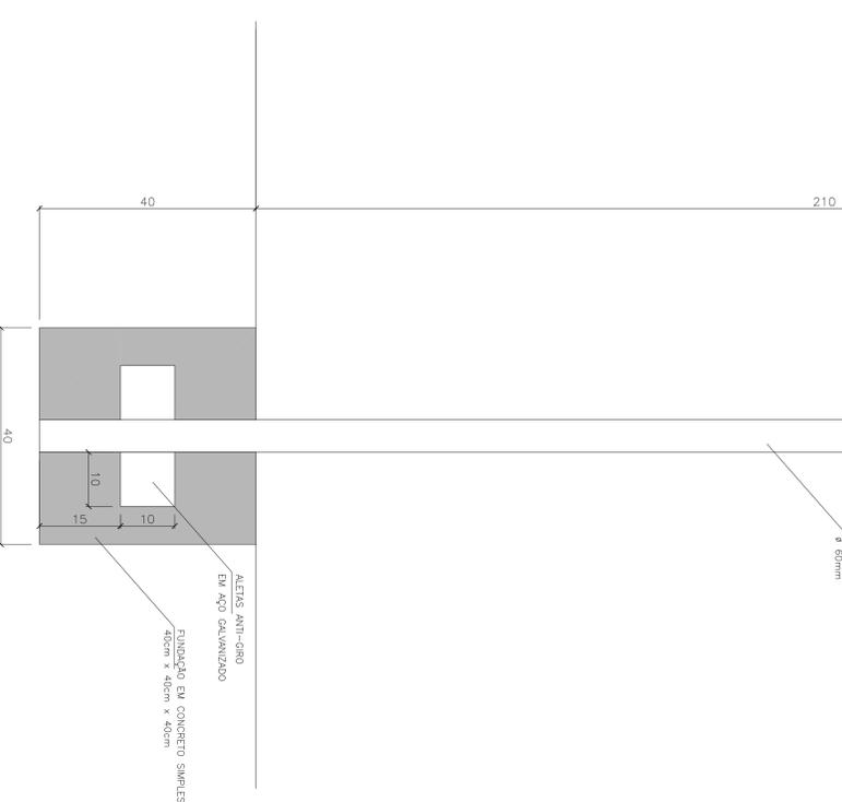
**EM CADA INTERSEÇÃO IMPLANTAR UM CONJUNTO DETALHADO ACIMA:
