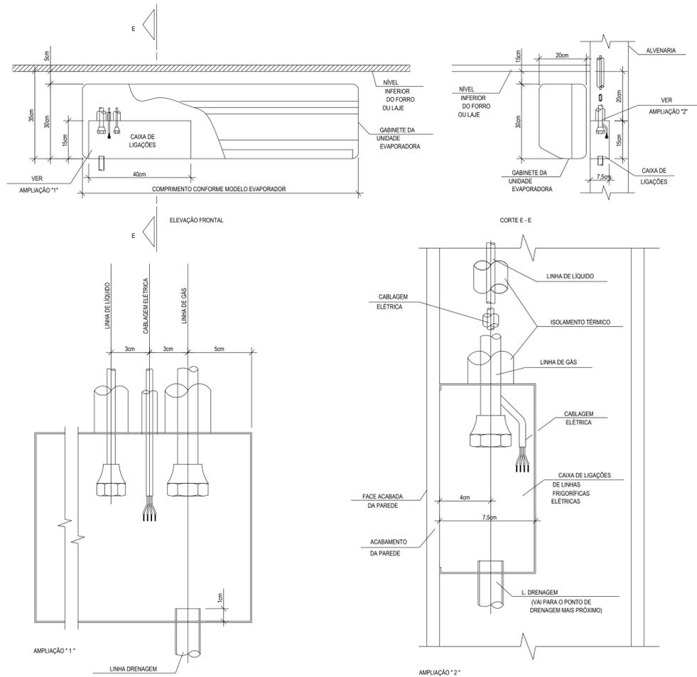
DETALHE TÍPICO PARA INSTALAÇÃO DE EVAPORADORAS S/ ESCALA
