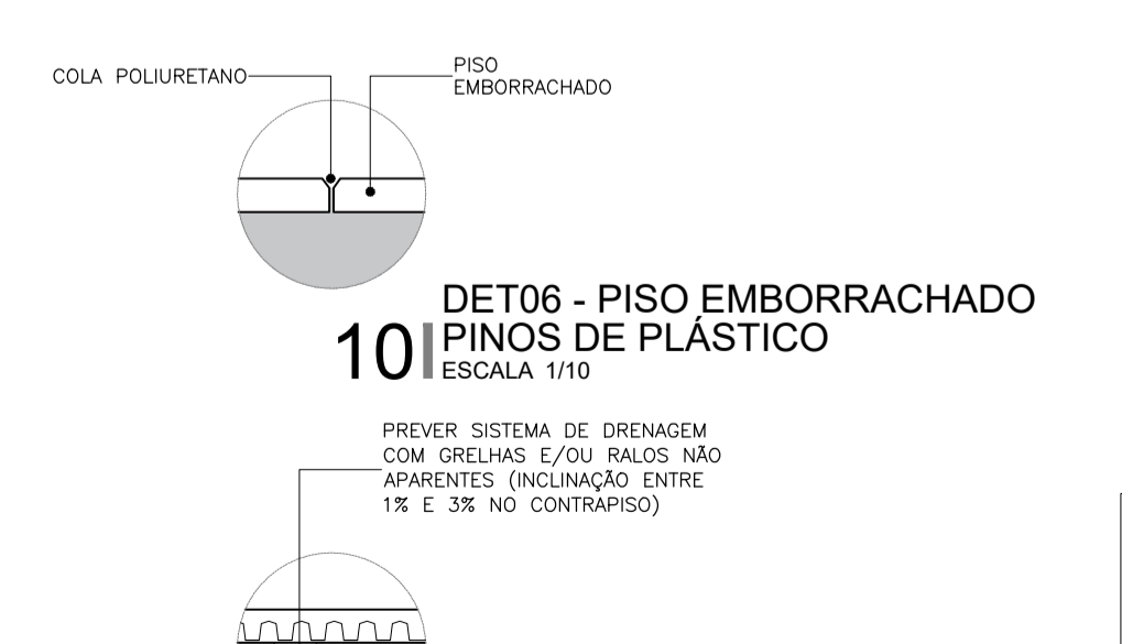
11 DET07 - PISO EMBORRACHADO DRENAGEM ESCALA 1/10
