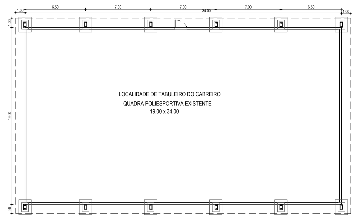
04 FUNDAÇÃO | TABULEIRO DO CABREIRO ESCALA: 1/200
