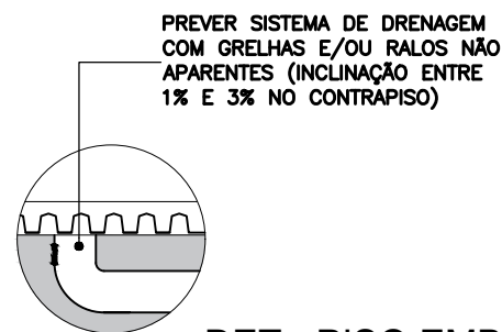
03 DET - PISO EMBORRACHADO DRENAGEM ESCALA 1/10
