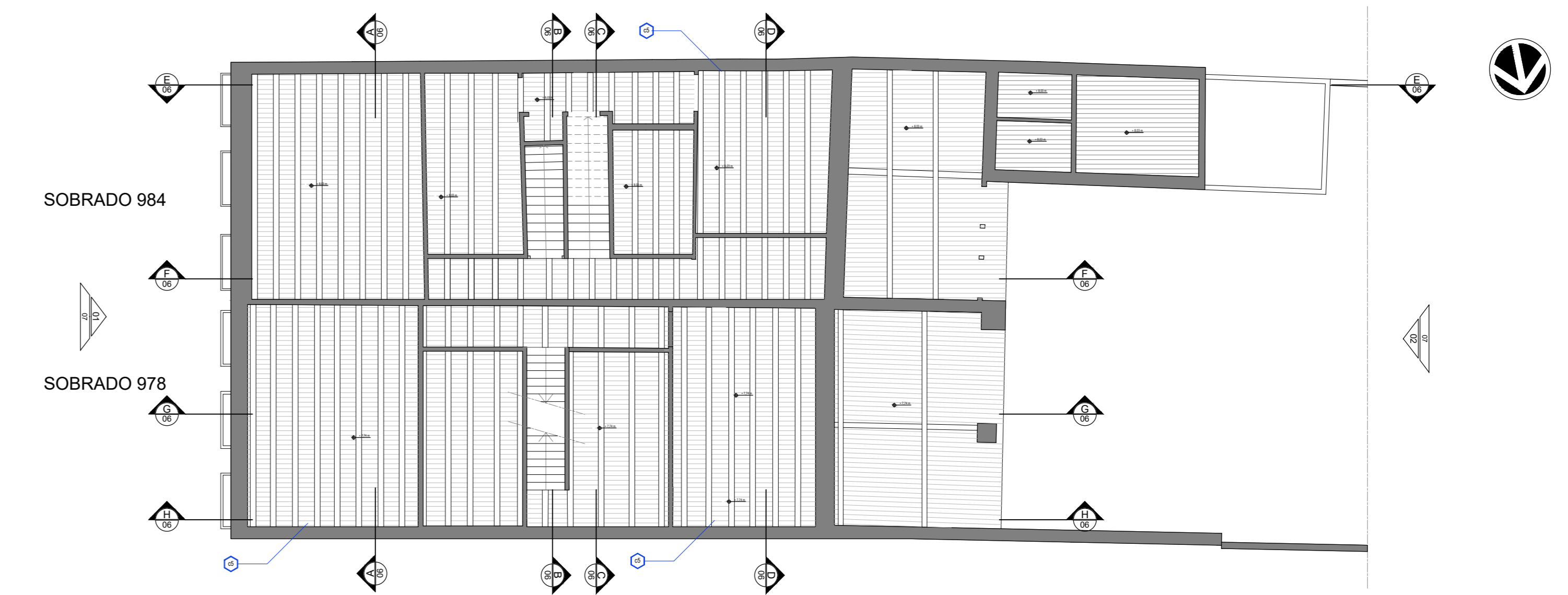
05 | PLANTA DE MADEIRAMENTO - PAV. SUPERIOR ESCALA 1:125
