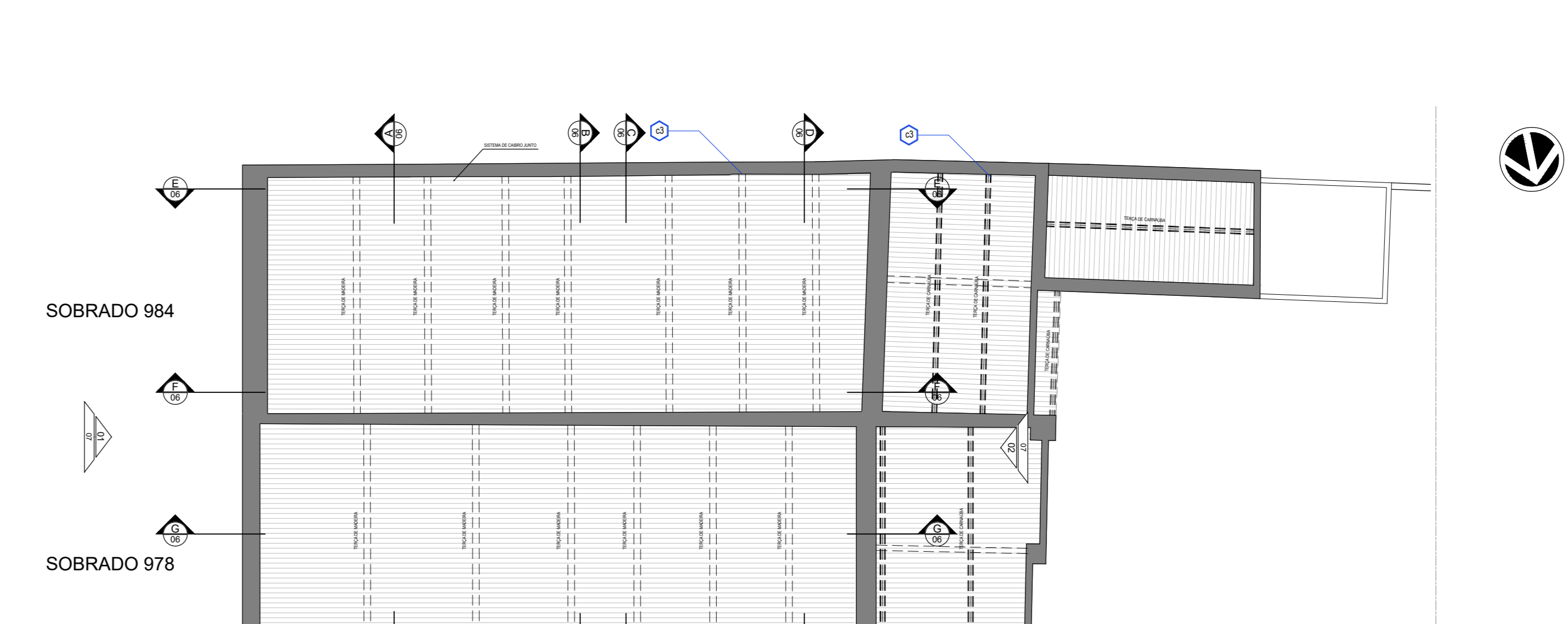
06 | PLANTA DE MADEIRAMENTO - SÓTÃO ESCALA 1:125
