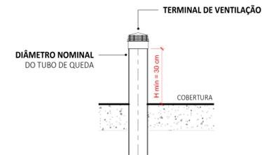
**2 DETALHE TERMINAL DE VENTILAÇÃO**
