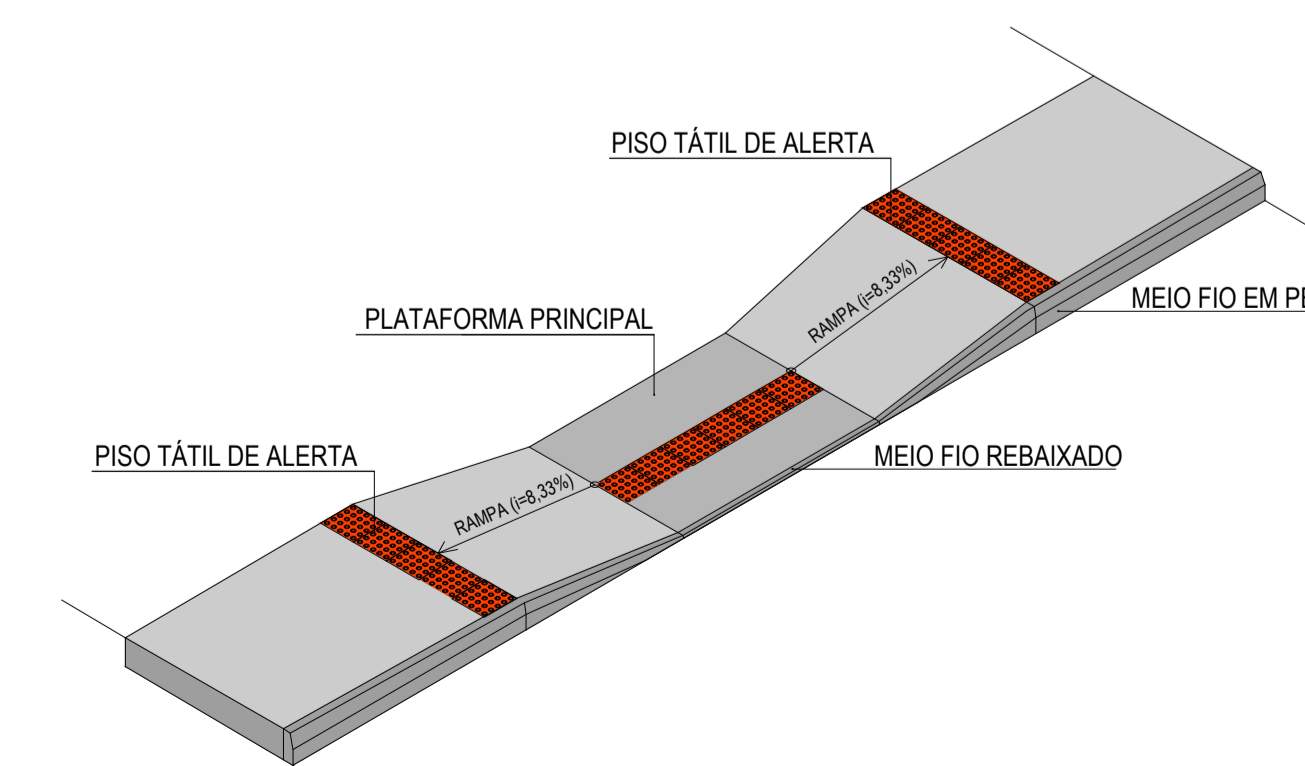
091 DETALHE - RAMPa PERSPECTIVA ESCALA 1/50
