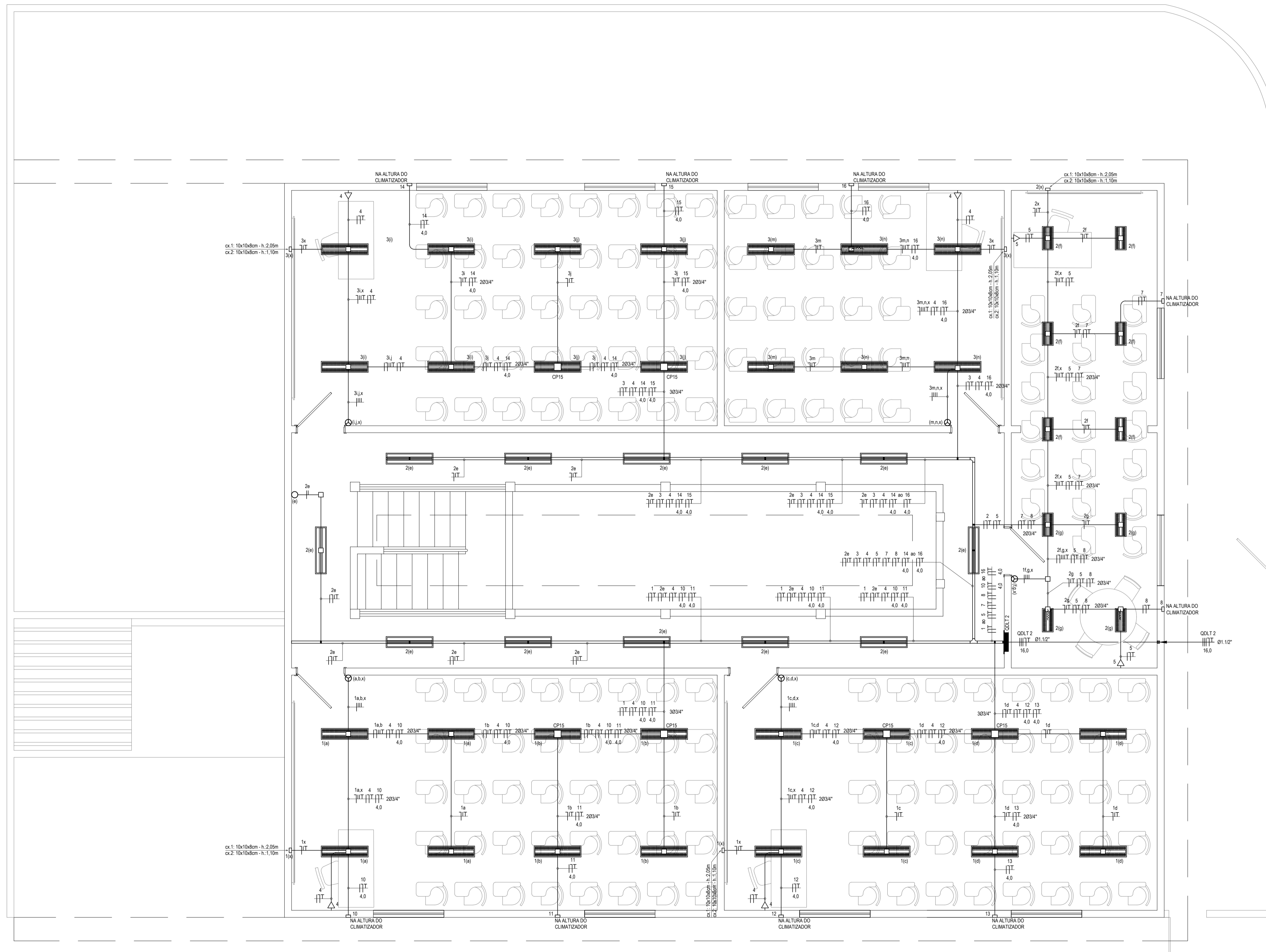
SUPERIOR - ILUMINAÇÃO E TOMADAS ESCALA: 1/50
