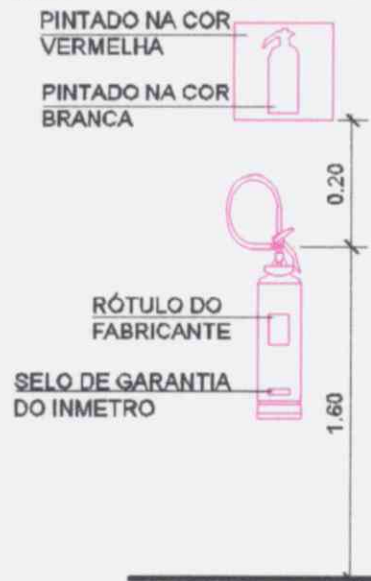
Figure 1 – Instalação dos extintores
