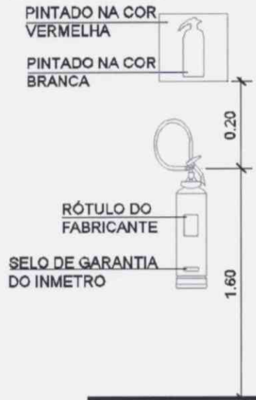
Figure 1 – Instalação dos extintores
