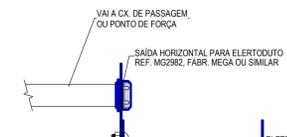
LIGAÇÃO ELETRODUTO P/ ELETROCALHA S/ ESCALA
