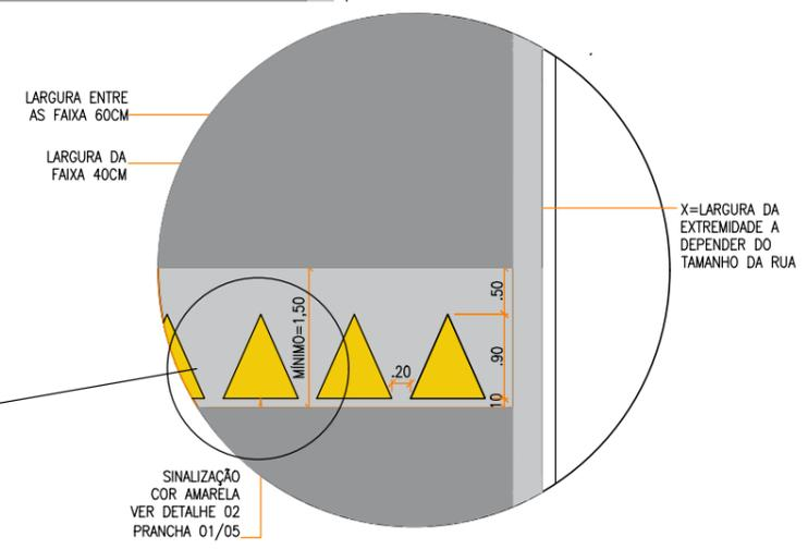
Obs.: este detalhamento deverá ser utilizado apenas como referência para estrutura da faixa elevada, devendo, em cada local que for implantado, ser realizado um estudo da estrutura com engenheiro capacitado.
