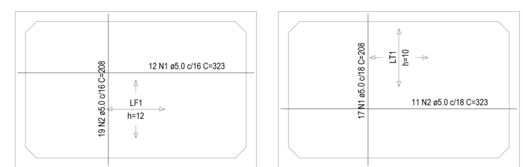
ARMAÇÃO POSITIVA DAS LAJES (390.0) Esc: 1/50
